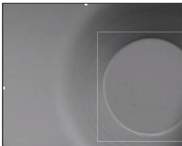
Figur 20.38 Exempel på felaktig brunnsposition i kameravyn
