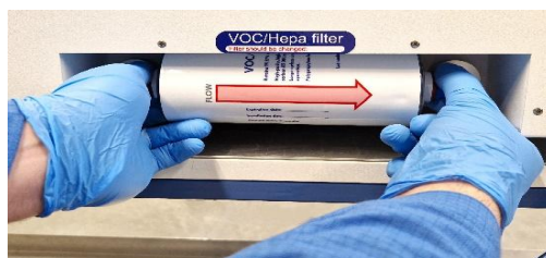
Figur 12.2 VOC/HEPA-filtrets insättnings- och borttagningsprocedur
